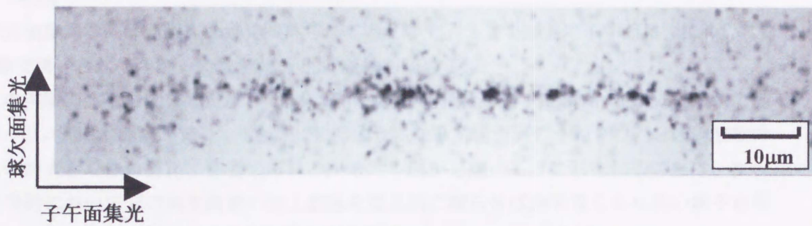
Fig.3.2.1 集光点におけるスポット像 (富士原子核乾板) 開口: 110\mu\text{m}(\text{V}) \times 120\mu\text{m}(\text{H})
