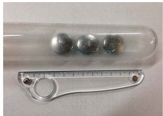
図2 合金インゴットの真空封入
