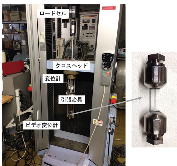
図 3 引張試験機と引張試験用の治具
