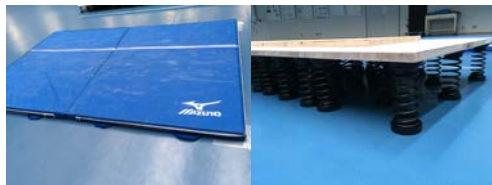
図 4 仮設走路に用いたマット (左) と弾性体を配置した走路 (断面) (右)
