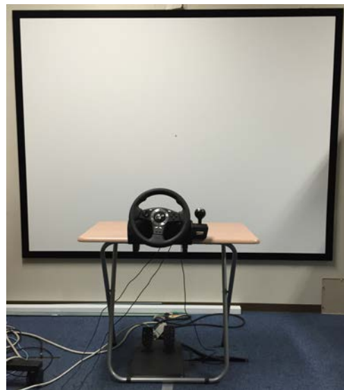
図2 簡易型ドライビングシミュレータ
