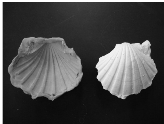
図 3. シリコンゴムの型(左)・セッコウの模型(右)
