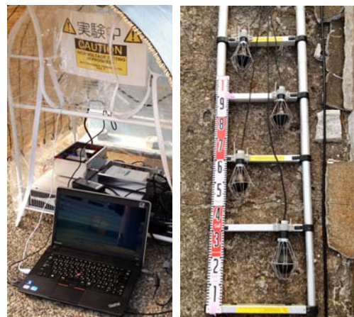
図 4：実海域試験の様子 (左：送信機の一部 右：受波アレイ)
