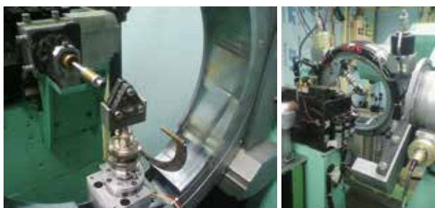
図3. 高圧単結晶X線回折測定。ゴニオメーターにセットした高圧発生装置(DAC)(左)と高エネルギー加速器研究機構放射光施設PF BL-10Aの四軸X線回折装置(右)
