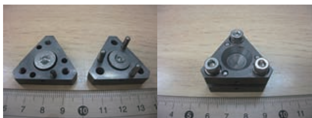
図3. 単結晶X線回折測定用ダイヤモンドアンビルセル。左は上下の台座を組み合わせる前、右は台座を組み合わせた後。
