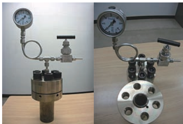
図1. オートクレーブ。 左は反応容器全体、右は上蓋をはずした容器内部。
