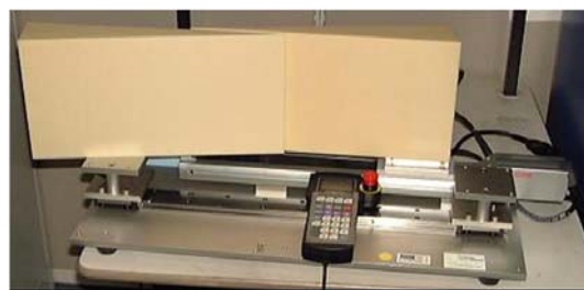
図1 並進型楔形レンジ変調器 (WRS) の概略図
