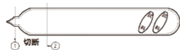
図9 真空封入管の切断開封
