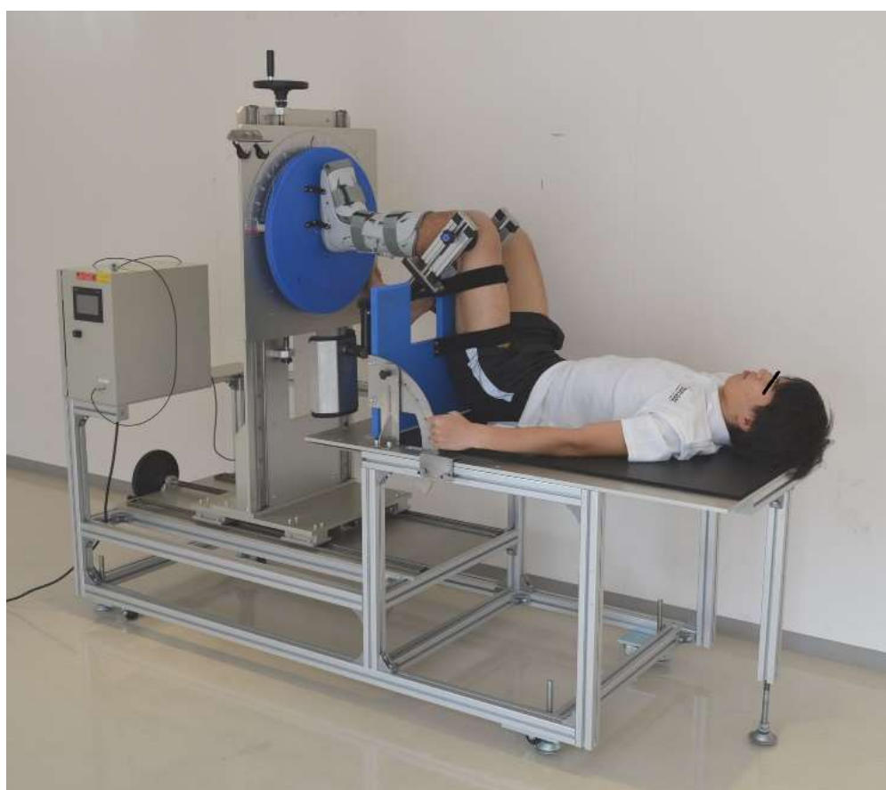
Figure 3 - 6c 測定時の肢位（膝関節 90°屈曲位）
