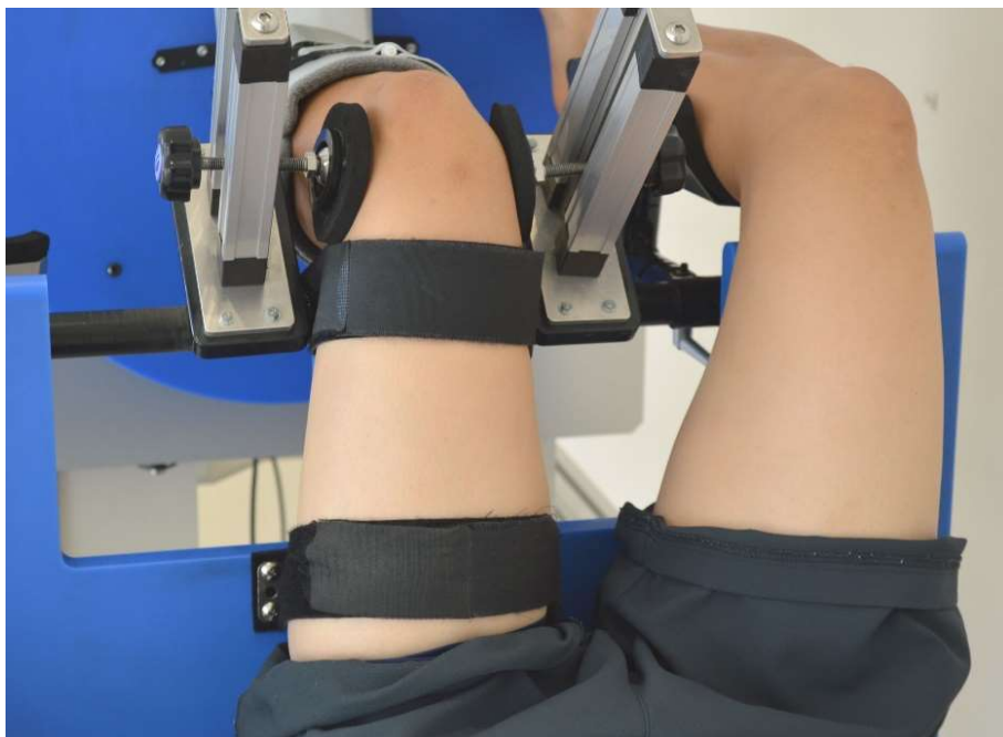
Figure 3 - 7 クランプおよびベルクロテープによる大腿部の固定方法
