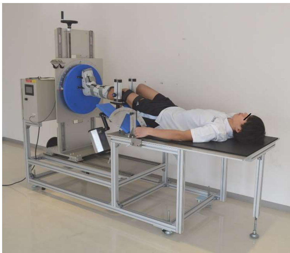
Figure 3 - 6a 測定時の肢位（膝関節 30°屈曲位）
