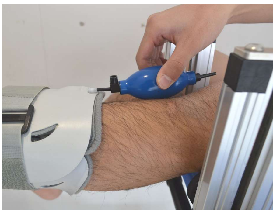
Figure 3 - 8 ハンドポンプによるエアバッグへのエア注入
