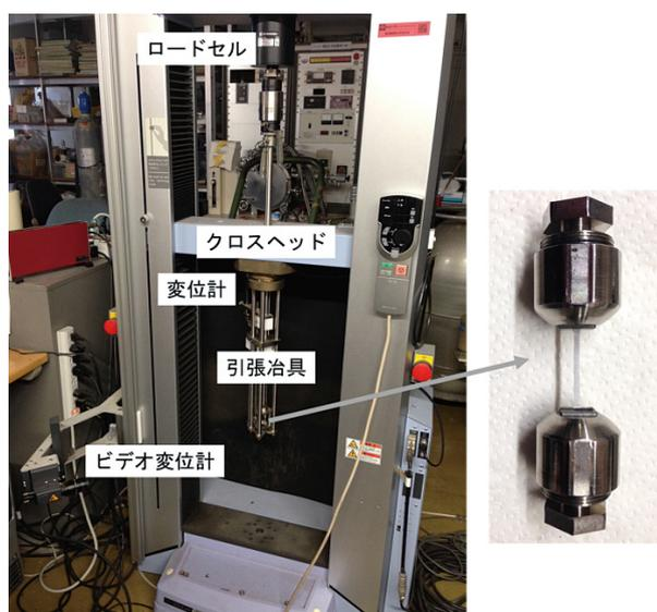
図 3 引張試験機と引張試験用の治具
