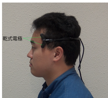
図 3.1.2: 電極装着例 (側面)
