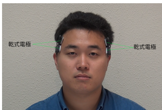
図 3.1.1: 電極装着例 (正面)
