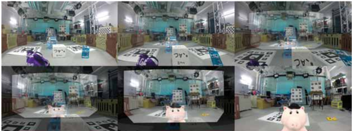
図 10 : 視点遷移映像 (上段左 Outside-In 映像から下段右 Inside-Out 映像間を視点 が移動したような映像が生成されている)
