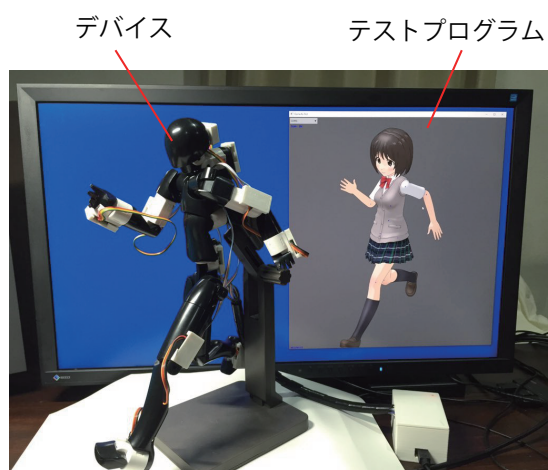
図 5.8: 開発中のデバイスと地磁気センサの情報を可視化する機能を追加したテストプログラム
