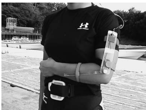
図1 ポテンシオメータと角速度計
