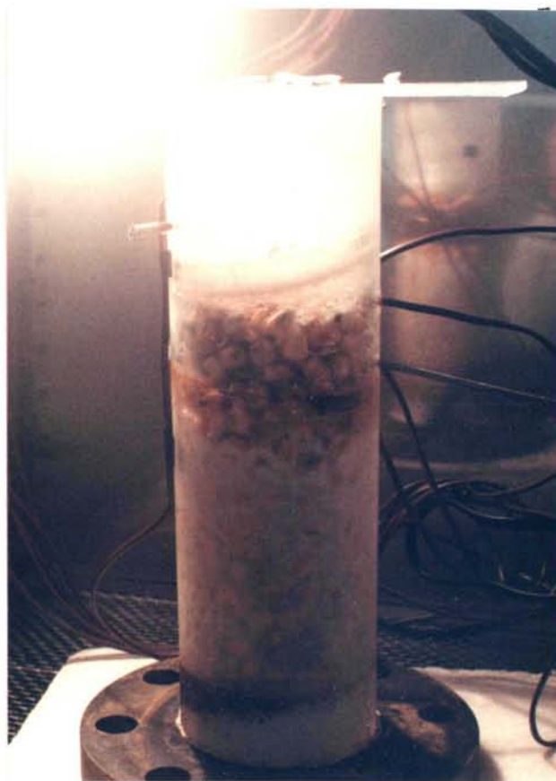
写真4 ・2 モデルサイロのヘッドスペース部での氷結の状態
