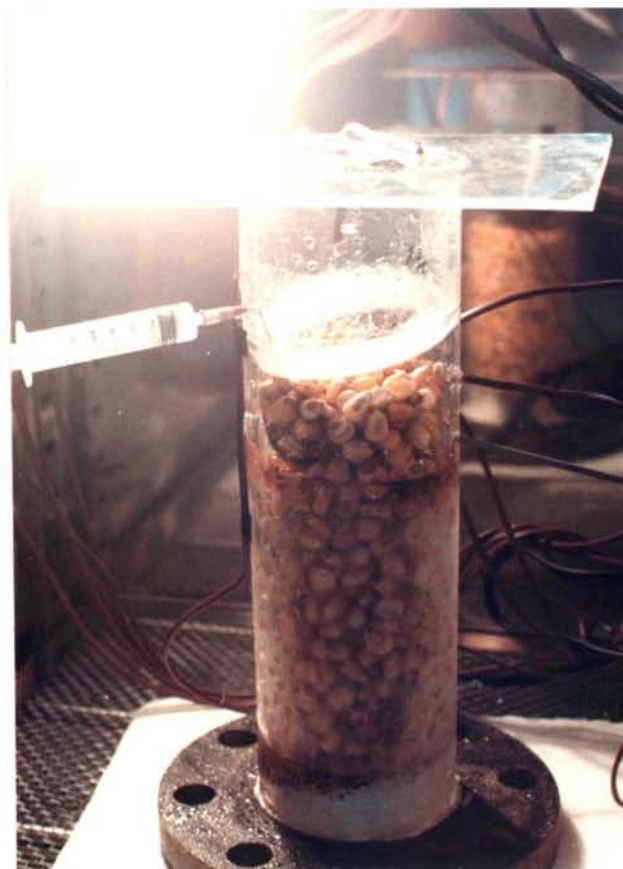
写真4 ・ 4 モデルサイロのヘッドスペース部の結露量の測定
