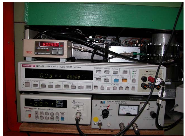
図5. 電流積分のためのピコアンメータ
