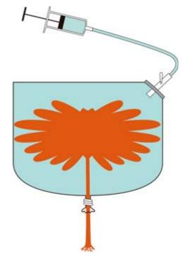
図 2. カジメ袋がけに用いた採水袋の模式図 底面の一端に開閉可能なプラスチックコックを取り 付けた。
