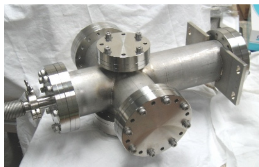
図 8. 最終リークテストを行っている。
