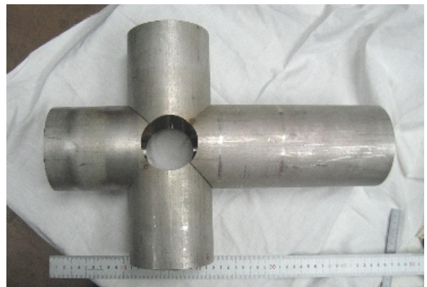
図 5. 点付けした 2 組がつながるか確認する。
