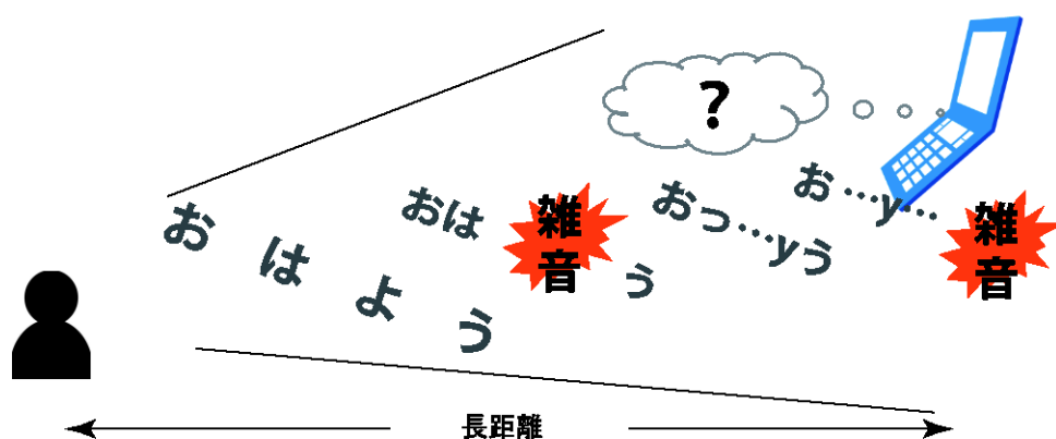
Fig. 1.3 センサ距離と雑音による問題点
