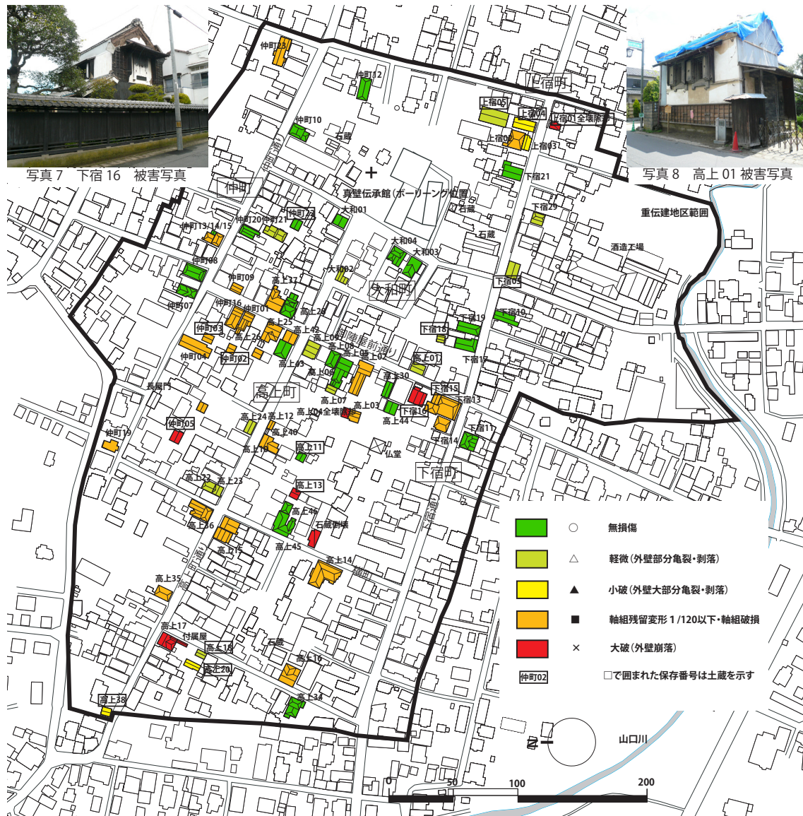
図5 真壁外壁・軸組損傷分布図〔町家・土蔵〕(出典：真壁保存地区計画図を基に編集)
