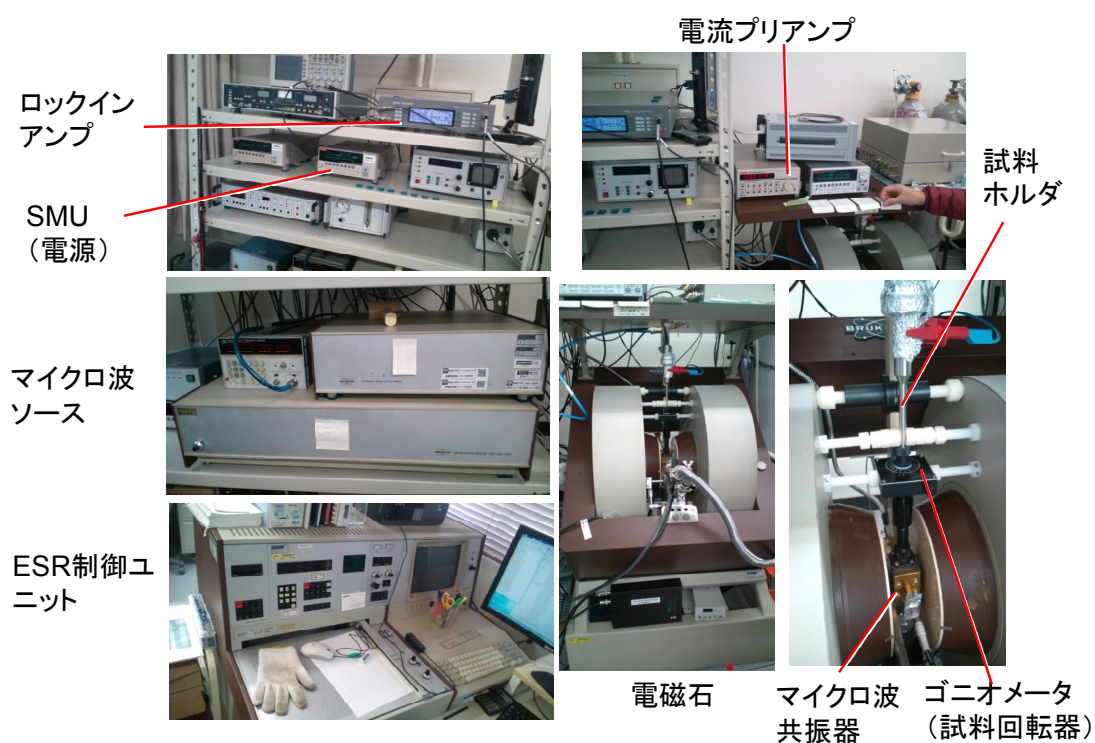
図 4-2-1 本研究で使用した EDMR の測定系
