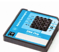
図 1. DNA1000 チップ サイズ 5 cm × 5 cm 調整ゲル 9 \mu l とサンプル 1 \mu l は直径 3 mm のサンプル孔に注入する
