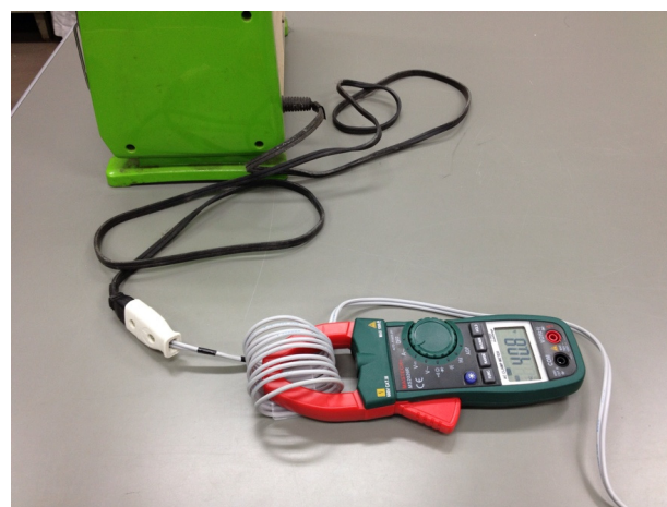
図 4. “ゲーム機等の消費電力を調べる”の実験風景
