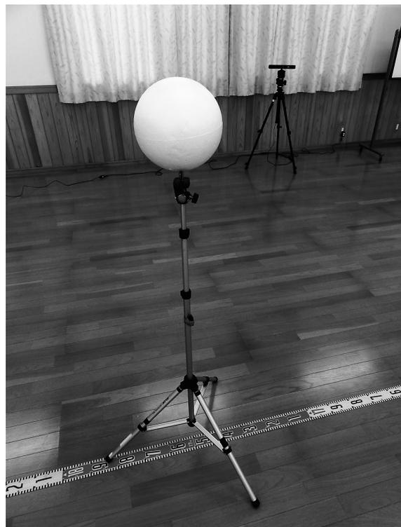
図3 キャリブレーション用発泡スチロール製白球(三脚上に取り付けてある)。
