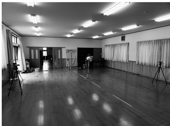
図2 実験を実施した部屋。被験者は、中央に見える巻き尺の左側を向こう向きに歩く。Kinect™は、歩行路正面と歩行路の左右にそれぞれ1台の計3台設置し、左手には歩行パラメータ計測用のビデオカメラも設置した。歩行路中心には、キャリブレーション用白球が置かれている。システムをコントロールするパーソナルコンピュータは画面右奥に設置されている。
