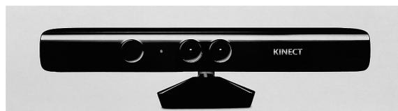
図1 Kinect<sup>TM</sup> 外観。3つの丸い穴は、向かって左から赤外線パターン投影機、カラービデオカメラ、赤外線パターン撮影カメラである。
