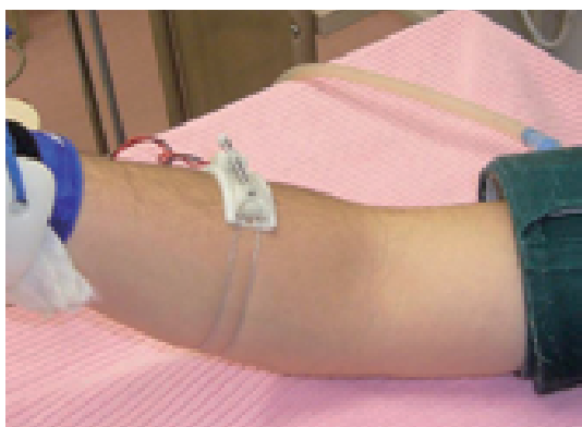
図2 前腕部に設置したストレインゲージ（白いパーツ：工作部門製作）
